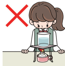
가열 중인 용기는 내려다보면 안 됨
