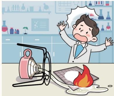
알코올램프를 이용한 실험을 하던 중 삼발이가 옆으로 넘어지며 실험대 위로 알코올램프의 유리병이 깨지고 알코올에 불이 붙는 화재 사고 발생
