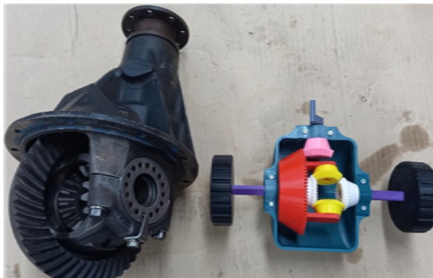
실제 자동차 차동장치와 솔리드워크스로 모델링하여 제작한 모형 차동장치 비교 [ 구동 피니언기어 : 분홍색(1개), 링기어 : 빨간색(1개), 차동 피니언기어 : 노란색(2개), 사이드 기어: 흰색(2개) ]
